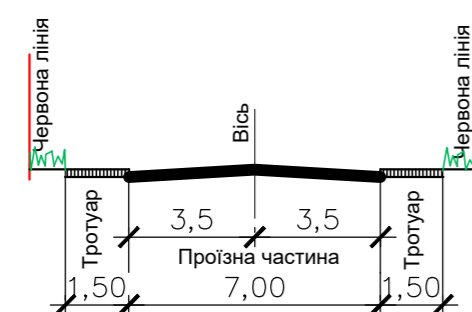
Поперечний переріз житлової вулиці
